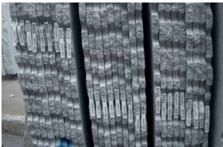
Particolare dei tag Rfid custom sulle lastre, appositamente progettati per soddisfare le richieste di Antolini
